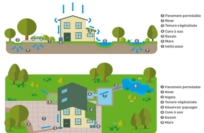
Exemple de différentes techniques alternatives possibles pour gérer les eaux pluviales d'une maison
